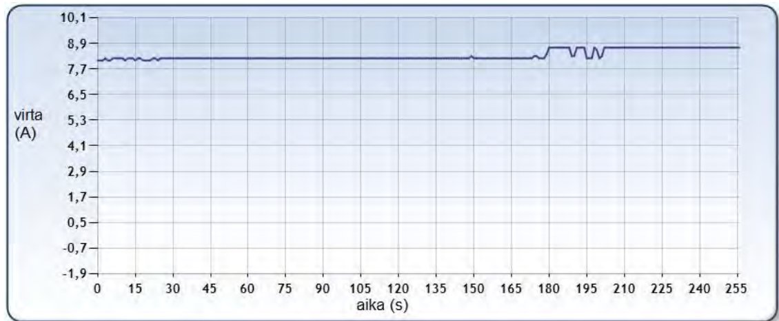
Kuva 65. Rinnakkaisvian ja maasulkuvian ilmenemismuoto virtamittauksessa..
