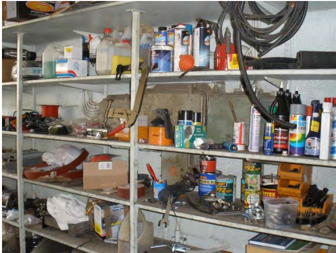
Kuva 36. Runsas palavien aineiden varastointi jakokeskusten läheisyydessä (@ Pertti Kukkonen, Oy Elspecta Ab).
