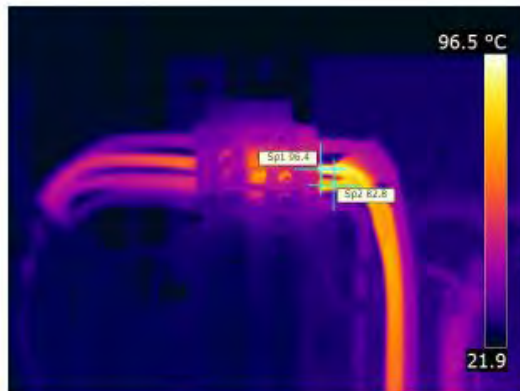
Kuva 42. Löystyneen riviliitinkytkennän vaikutus johtimen ja liittimen lämpötilan nousuun (© Hannu Halminen, Bolden Harjavalta Oy).
