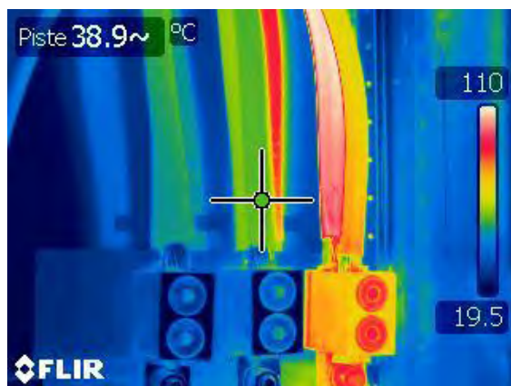
Kuva 47. Liitoksen vikaantumisen aiheuttama lämpenemä liittimessä ja johtimessa (© If Turvakatemia).
