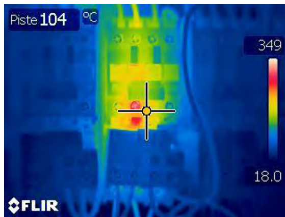
Kuva 46. Puutteellisen liitoksen aiheuttama lämpenemä kontaktorin ja lämpöreleen välissä (© If Turva-akatemia).
